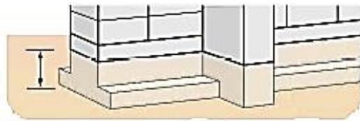
★ 控壁がない、または控壁の間隔が3.4mを超える。
